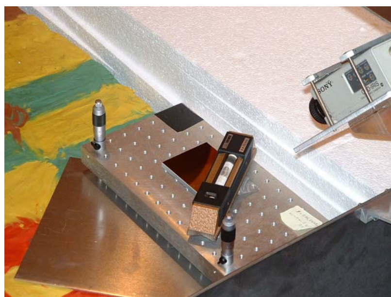
Die Präzisionswasserwaage liegt auf einem Metallbrett, welches durch die beiden Stellschrauben an den Seiten exakt waagrecht ausgerichtet werden kann.
